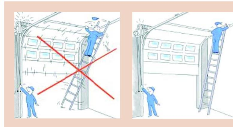
**Exigence.** Lorsqu'un fonctionnement manuel est possible sur une porte motorisée, celle-ci doit être conçue de sorte que le fonctionnement manuel puisse être exécuté sans risque.
