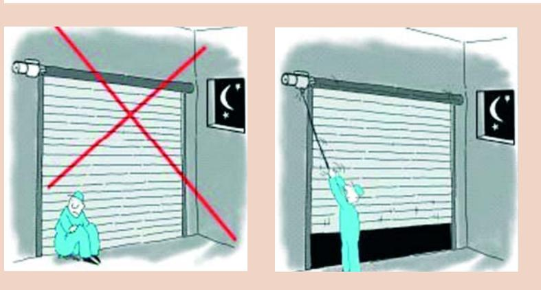
**Exigence.** Il ne doit pas être possible que des personnes soient piégées dans des zones où une porte motorisée est la seule issue possible, même en cas de défaillance de la motorisation ou de l'alimentation en énergie.
