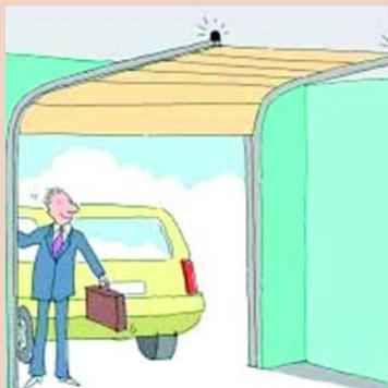
**Exigence.** Le tablier de la porte doit s'arrêter automatiquement et en toute sécurité lorsqu'il atteint ses positions limites de fin de course. Le mouvement de la porte doit également s'interrompre et la motorisation être mise hors circuit dès qu'un ordre d'arrêt est donné.
