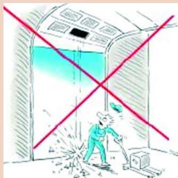
**Exigence.** Les éléments transparents des vantaux doivent être conçus de manière à rester parfaitement assujettis dans les conditions de fonctionnement normal. En cas de rupture du matériau transparent, aucun éclat pointu, arête tranchante ou autres parties dangereuses ne doivent apparaître.
