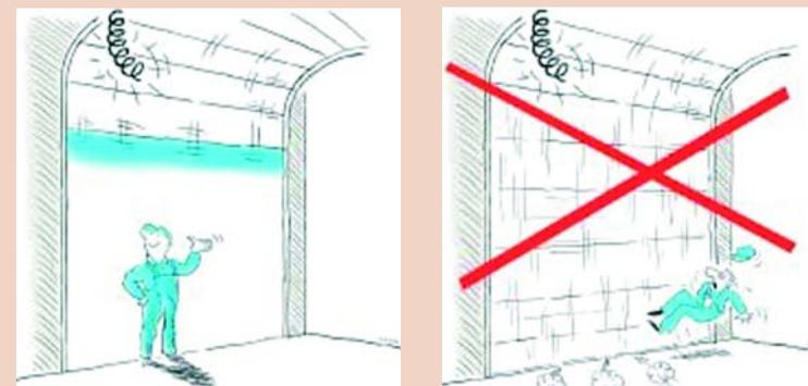
**Exigence.** Les vantaux des portes à mouvement vertical doivent être protégés contre la chute ou contre les mouvements de déséquilibre incontrôlés en cas de défaillance d'un seul composant du système de suspension ou d'équilibrage. La porte doit être dans l'incapacité de se fermer si la défaillance d'un composant se produit.
