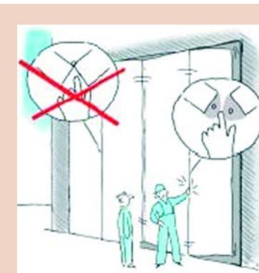
**Que faire.** Les caractéristiques mécaniques d'une porte doivent être conçues de manière à éliminer tout risque d'écrasement, de coupure, de cisaillement d'emmêlement, d'entraînement et de coincement pour l'opérateur ou les personnes se trouvant à proximité.
