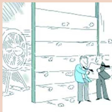
**Exigence.** Une charge appliquée sur la porte ne doit pas provoquer d'effondrement, de déformation permanente, de déraillement ou de défaut quelconque ayant des conséquences sur la fonctionnalité et la sécurité du produit.
